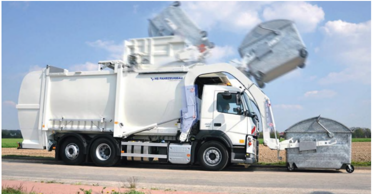
Abb. 14 Beispielbild ASF mit Frontladesystem (Quelle Terberg)
