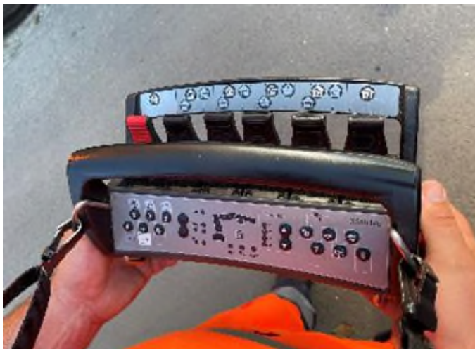
Abb. 19 Fernsteuerung zur Bedienung des Fahrzeugkrans
