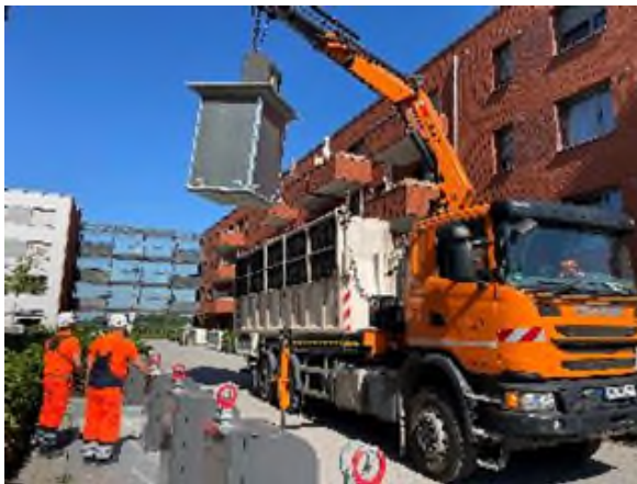
Abb. 16 Aufnahme von Unterflurbehältern (Abfallsammlung mit und ohne Presseinrichtung)
