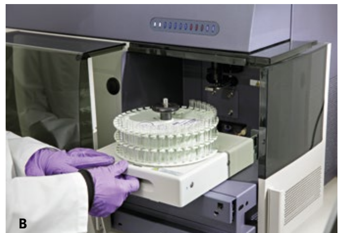
Abbildung 1 (A) Am Fluoreszenzmikroskop wird die Anzahl von Mikrokernen manuell erfasst und dauert ca. 15-40 Minuten je Probe beziehungsweise 2.000 Zellen. (B) Mit Hilfe eines Durchflusszytometers (FACS) können Kerne und Mikrokern in hoher Geschwindigkeit gemessen werden (Dauer: ca. 3-10 Minuten je Probe bzw. 20.000 Zellkerne).
