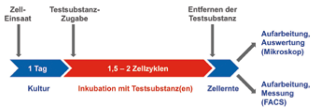
Abbildung 2: Experimentelles Design und zeitlicher Ablauf des MN-Tests in vitro .
