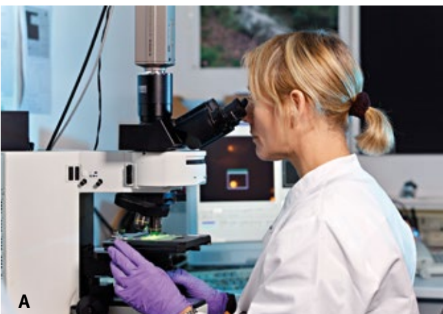
Abbildung 1 (A) Am Fluoreszenzmikroskop wird die Anzahl von Mikrokernen manuell erfasst und dauert ca. 15-40 Minuten je Probe beziehungsweise 2.000 Zellen. (B) Mit Hilfe eines Durchflusszytometers (FACS) können Kerne und Mikrokern in hoher Geschwindigkeit gemessen werden (Dauer: ca. 3-10 Minuten je Probe bzw. 20.000 Zellkerne).
