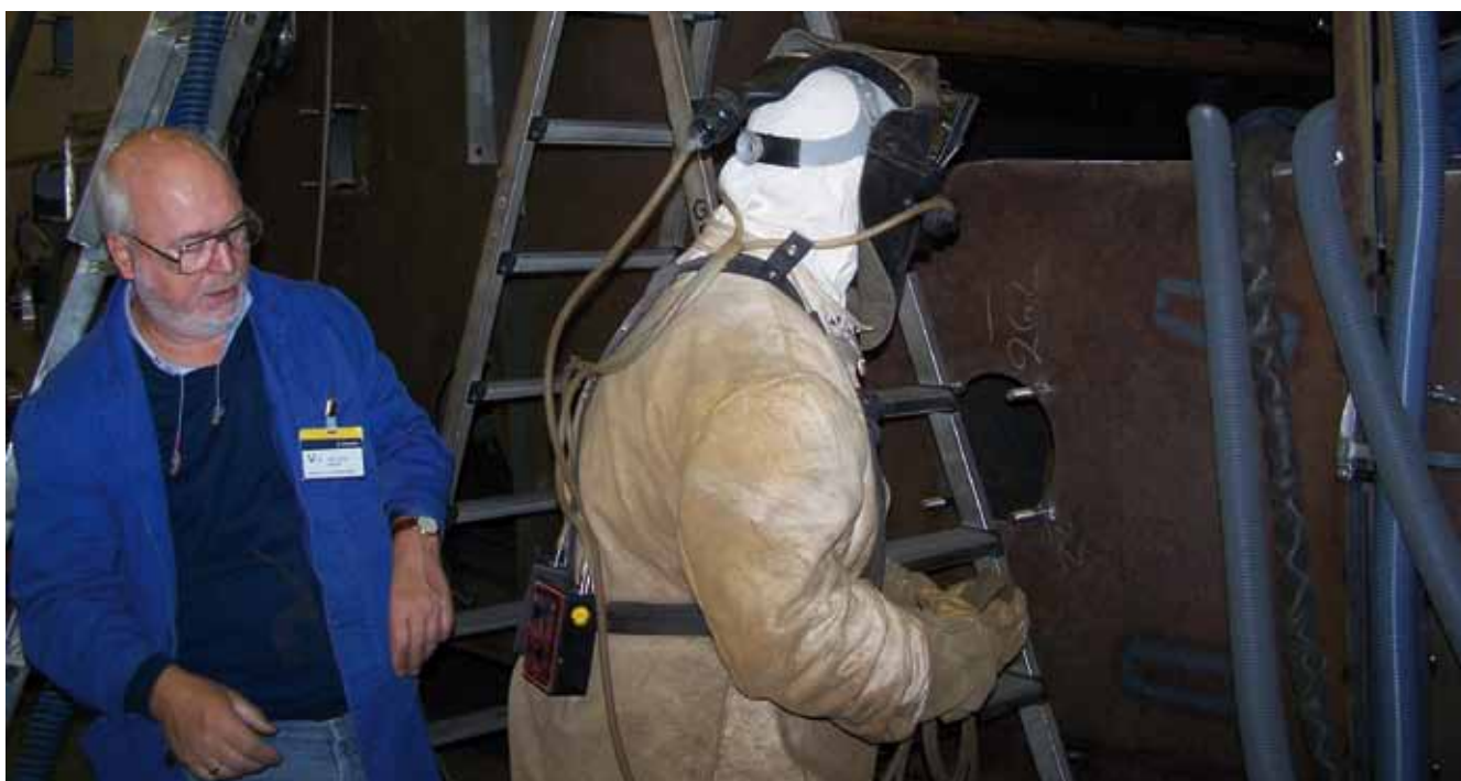
Zusätzlich zu ihrer umfangreichen persönlichen Schutzausrüstung trugen die Schweißer verschiedene Geräte während der Messungen.
