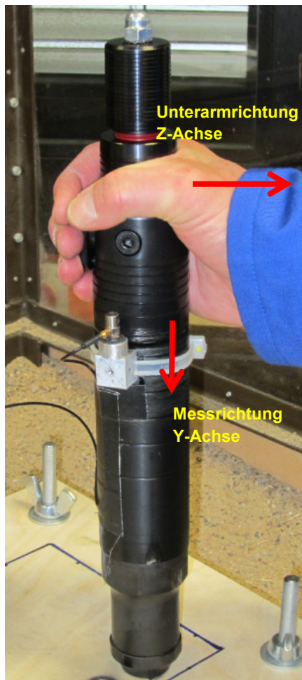
Bild 2: Versuchsaufbau, Ersatzverfahren im Sandbett mit Kabine für Absaugung
