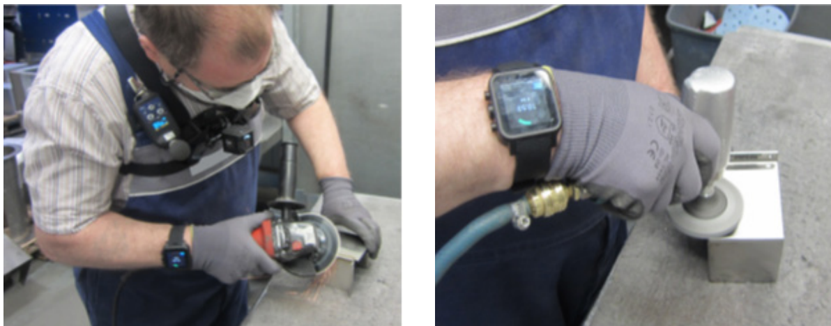
Bild 9: Nutzung von Arbeitsgeräten (Gerät 1 und Gerät 3) im Feldtest, mit Smartwatch und Videoerfassung
