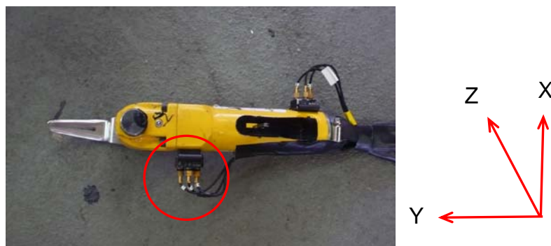
Bild 1: Die Anbringung des Beschleunigungsaufnehmers (Messpunkt rot eingekreist) für die Hand-Arm-Vibration und Lage der Messachsen
