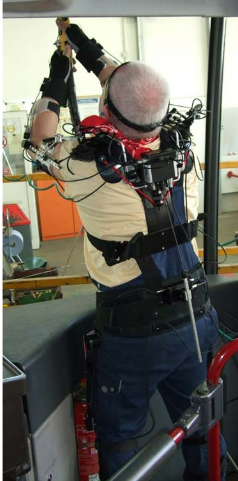
Bild 2: Das CUELA-System zur Messung der Körperhaltungen des Rumpfes, der Beine, der Hände, Arme und Schultern
