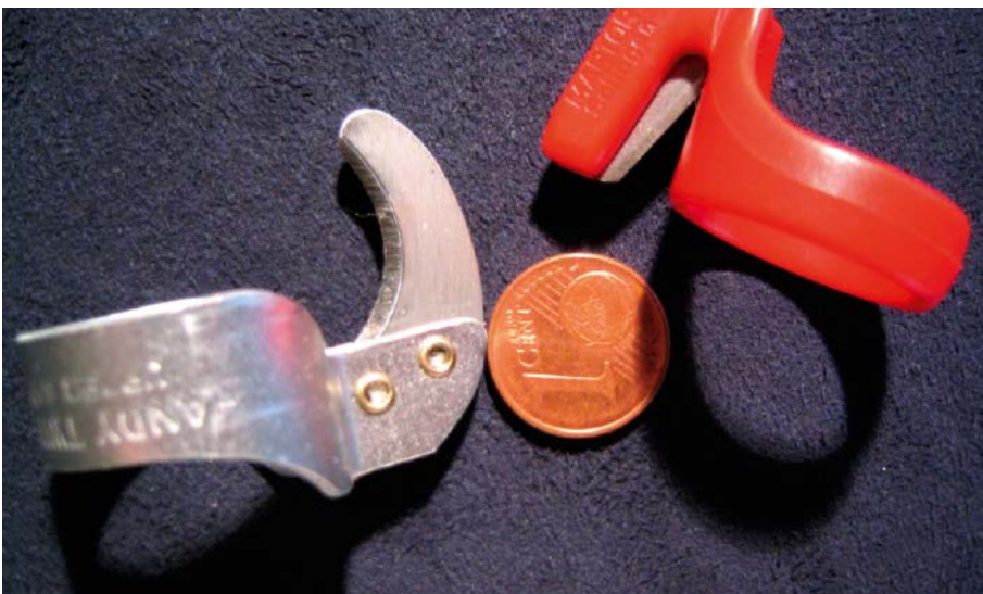
Abb. 6: Diese Fingermesser werden wie ein Ring über den Finger gestreift, so kann man ohne Unterbrechung der Arbeit durch zusätzliche Handgriffe z.B. Schnüre abtrennen.
