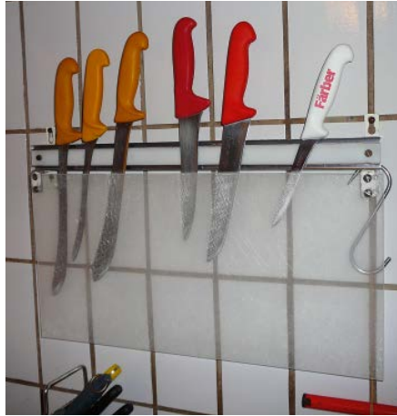
Abb. 4: Magnet-Messerhalter an der Wand. Durch die Plexiglasscheibe sieht man die (gegen Herunterfallen gesicherten) Klingen, was die sichere Auswahl des gewünschten Messers ermöglicht.
