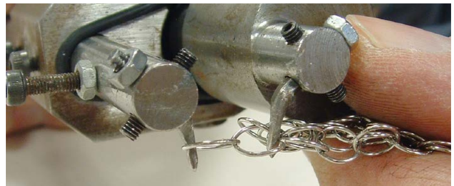
Abb. 2: Prüfung der Zugfestigkeit der Schweißverbindungen an den Ringen einer Stechschuttschürze
