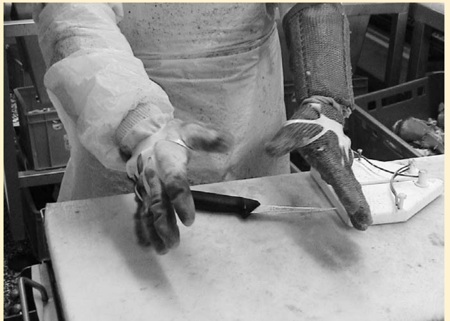
Abb. 3: Kunststoff-Straffer werden sowohl an der materialhaltenden Hand (Metallringgeflecht) als auch am schnitthemmenden Handschuh (Kevlar- oder Spectra-Gewebe) zur Optimierung der Passform genutzt.
