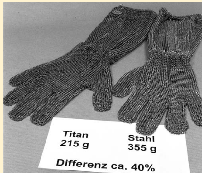
Abb. 5: Vergleich Titan- und Stahlringgeflecht-Handschuh.
