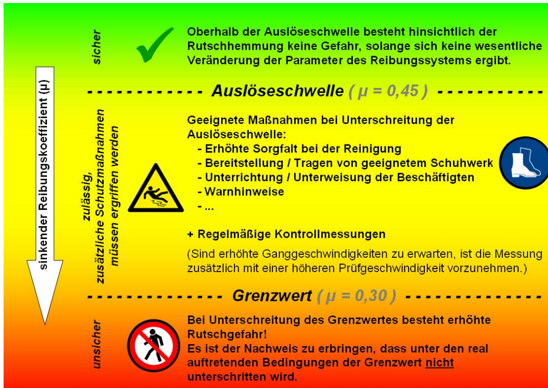
Abb. 2: Schutzkonzept 'Auslöseschwelle und Grenzwert des Reibungskoeffizienten beim Gehen' [Sebald, J.; 2007 1 ]
