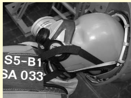
Abb. 3b: Abgerissener Filter
