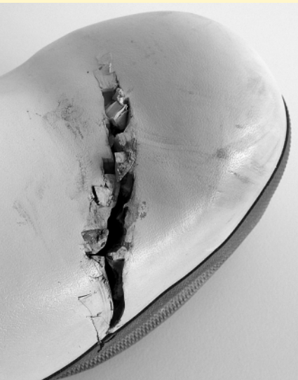
Abb. 1: Schnittverletzung – Eingeschnittener Sicherheitstiefel S5
