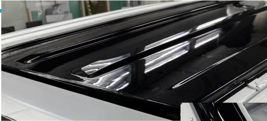
Strukturiertes Dach mit Höhenstufen
