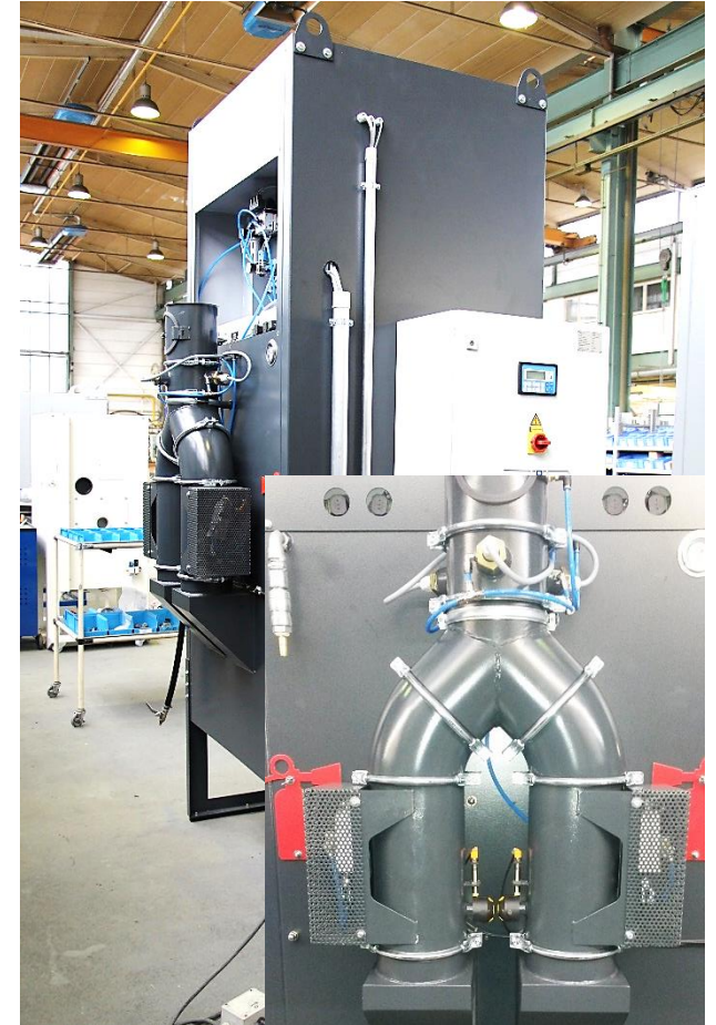
Bild 1 u. 2: Trockenabscheider mit Offlineabreinigung, Brand- und Funkenerkennung
