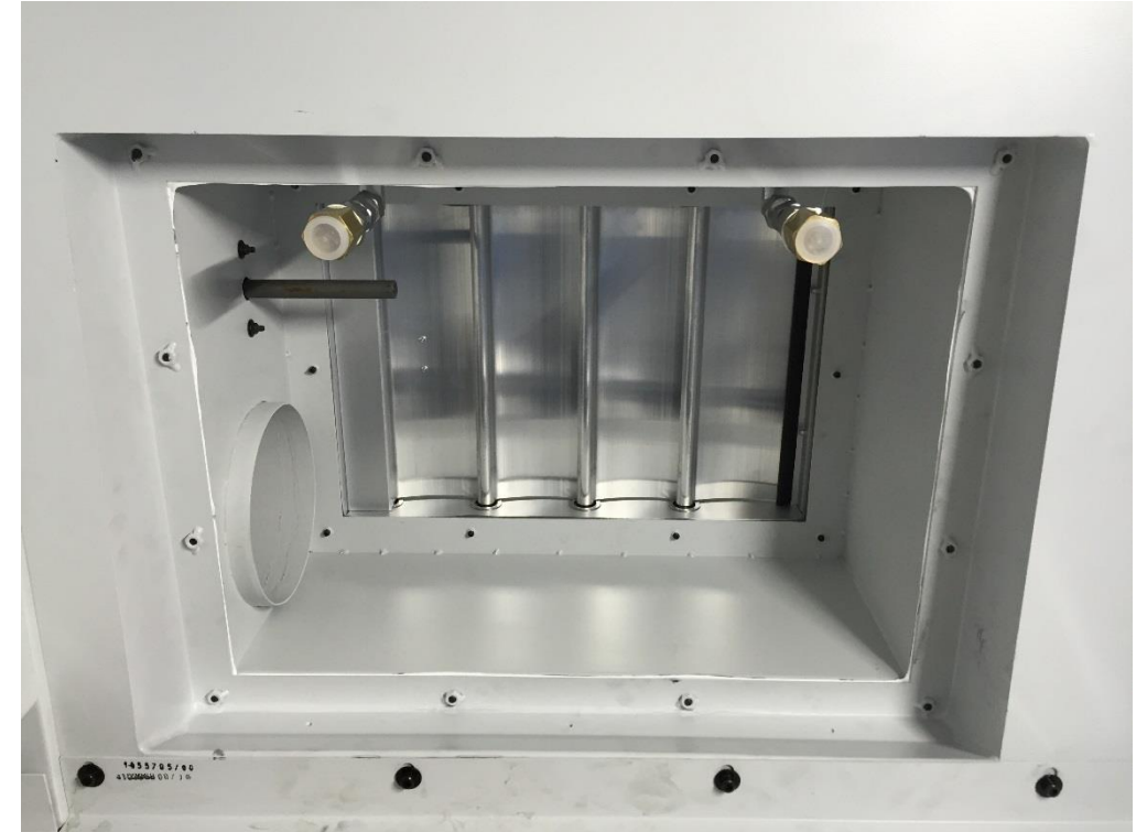
Bild 3: Bsp. Kombination Erfassung- und Druckentlastungseinrichtung in WZM Quelle: CHIRON-WERKE
