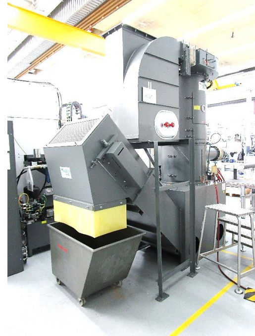
Bild 1 u. 2: Abscheidersystem für Leichtmetall-Späne und Staub. Quelle: CHIRON-WERKE
