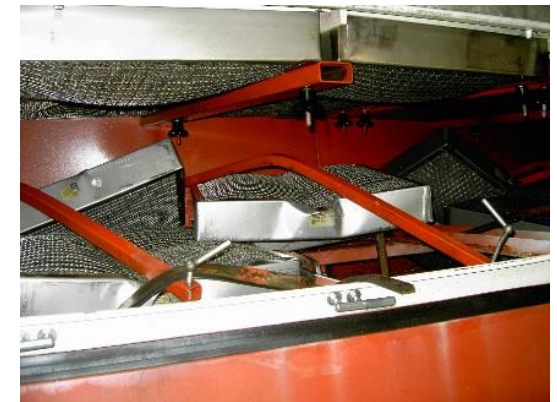
Bild 2: Ölnebelabscheider nach Verpuffung in WZM.
