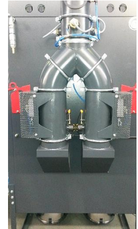
Bild 1: Bsp. Funkenerkennung in Kombination mit Offlineabreinigung an einem Trockenabscheider
