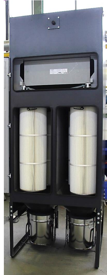
Bild 1 u. 2: Trockenabscheider mit Offlineabreinigung, Brand- und Funkenerkennung
