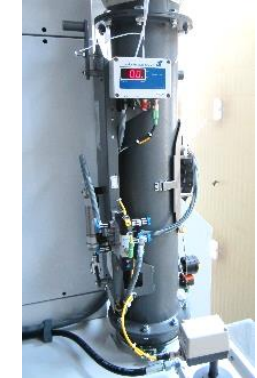
Bild 1 u. 2.: Beispiele Überwachung Mindestvolumenstrom Quelle: CHIRON-WERKE
