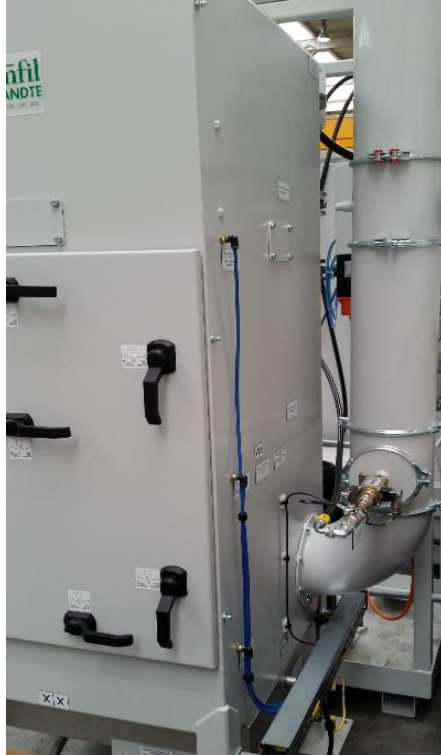
Bild 1: Bsp. Benetzungseinrichtung für Leichtmetallstäube bei Kombination Nass-/Trockenbearbeitung von Magnesium
