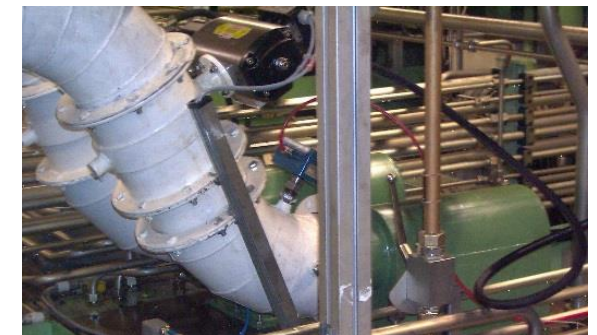
Bild 2: Bsp. Entkoppelungseinrichtung – schnell-schliessende Klappe < 250 msek
