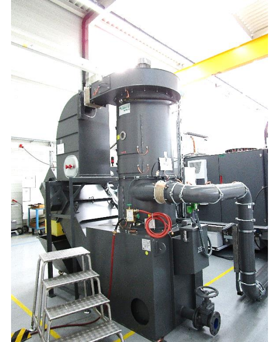
Bild 1 u. 2: Abscheidersystem für Leichtmetall-Späne und Staub. Quelle: CHIRON-WERKE
