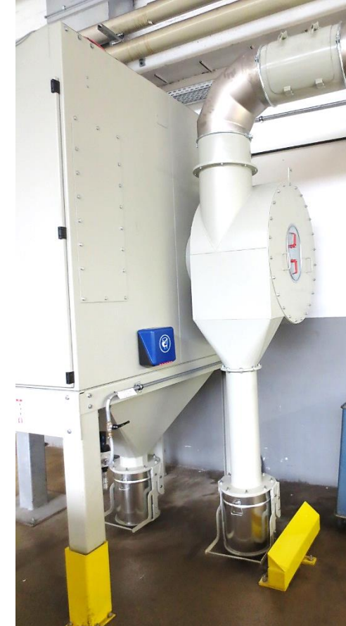
Bild 1: Bsp. Trockenabscheider mit Späne- und Funkenvorabscheider
