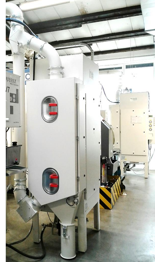
Bild 1: Abscheidersystem für „Quasi“-Trockenbearbeitung (MMS) und Vollschmierung an Bearbeitungsmaschine
