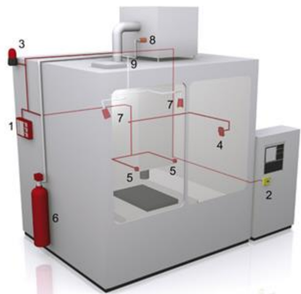
Abbildung 1 – Feuerlöschanlage in einer Werkzeugmaschine
